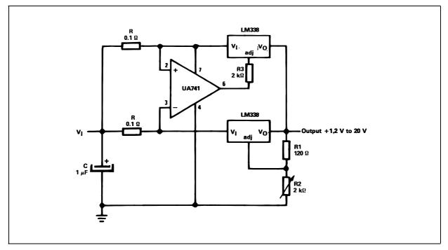
\* Minimum Load -100mA  $V_I \ge 10V$   $V_O \ge 3V$   $V_I$  -  $V_O \ge 3.5V$
