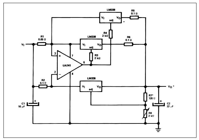
\* Minimum Load -100mA  $V_I \ge 10V$   $V_O \ge 3V$   $V_I$  -  $V_O \ge 4V$
