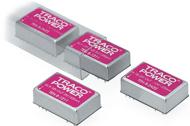
Die TEN 8 Serie sind 8 W DC/DC-Konverter mit hoher Leistungsdichte, weitem 2:1 Eingangsbereich in einem DIL-24 Gehäuse mit Industriestandard-Pinning. Der sehr hohe Wirkungsgrad ermöglicht einen erweiterten Arbeitstemperaturbereich von -40 °C bis +85 °C. Der integrierte Filter nach EN 55022, Klasse A ohne externe Komponenten minimiert Entwicklungszeit und -kosten. Weitere Merkmale sind die Extern Ein/Aus-Funktion und die Dauerkurzschlussfestigkeit.
